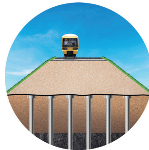
Construcción de terraplenes sobre pilotes
