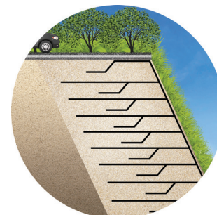
Construcción de estructuras de tierra reforzada
