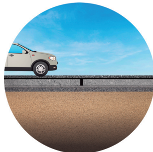
Rehabilitación de pavimentos rígidos con carpeta asfáltica
